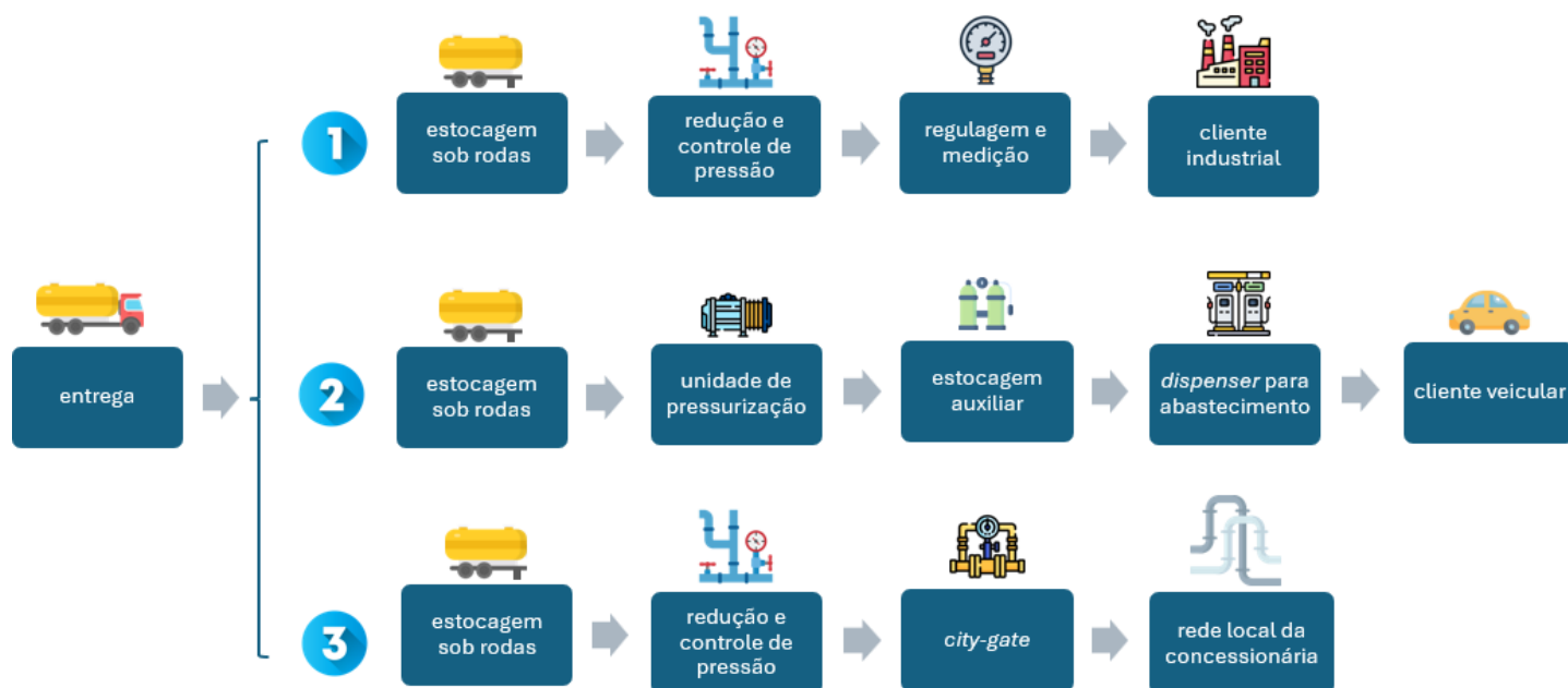
Figura 7 - Diagrama de diferentes aplicações em pontos de entrega de GNC Fonte: Elaboração própria a partir de ULTRAGAZ (2024)
